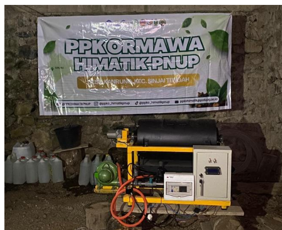
Gambar 3. 1 Fisik mesin Smart Clove-Dryer berbahan stainless steel SS304 dengan pemanas hibrida terkendali IoT
