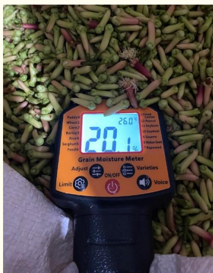
Gambar 25 Foto penggunaan moisture meter
