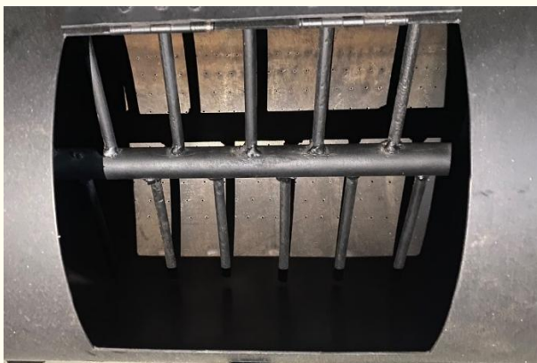
Gambar 4 Foto komponen mekanik as besi dan paddle
