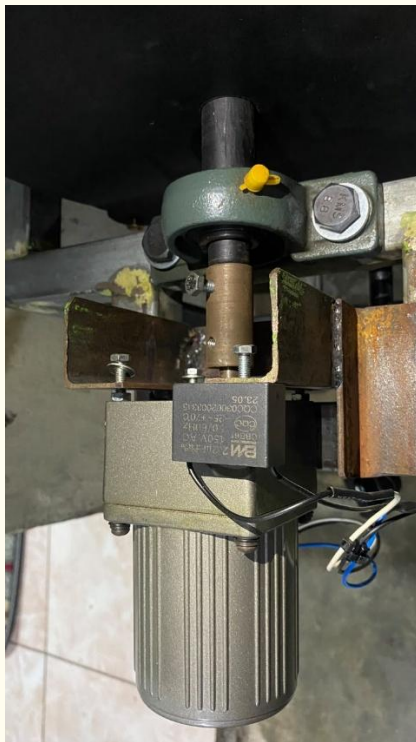
Gambar 5 Foto komponen mekanik Motor AC Gearbox
