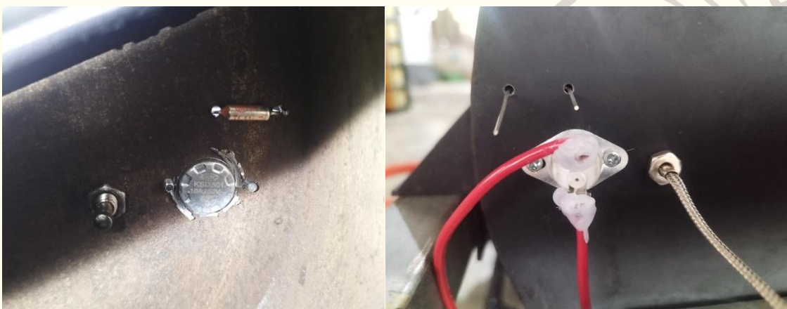
Gambar 26 Foto thermal fuse
